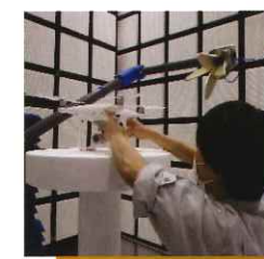
ドローンの無線性能評価の様子
