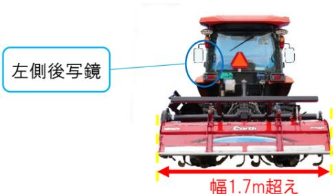
② 農耕トラクタ単体の大きさを含め、農作業機を装着した状態で幅が2.5mを超えていないか確認しましょう。
